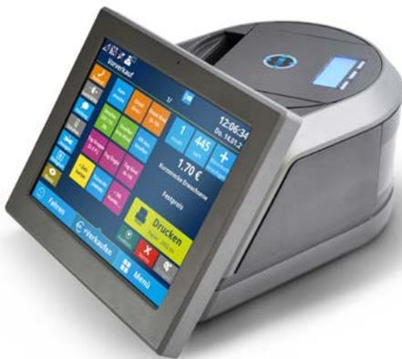
Die IVU.ticket.box ist die digitale Schaltzentrale im Bus. Der integrierte Bordrechner erfasst alle Vorgänge, kommuniziert mit der Leitstelle, druckt Fahrscheine, und validiert E-Tickets.
