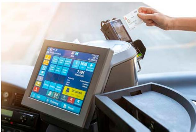
Die IVU.ticket.box mit dem Bezahlterminal P400 von Verifone beschleunigt den Bezahlvorgang beim Zustieg.
